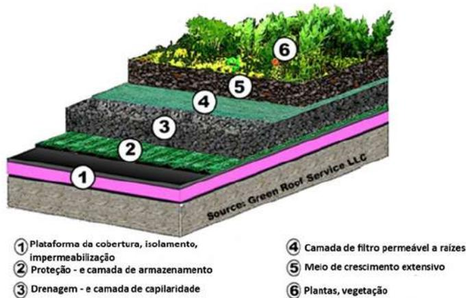
Figura 4: Exemplo de camadas de um teto verde extensivo. Fonte: Green Roof Service LLC, in SuDS Wales, 2024b, p. 1, trabalhada pela autora. Disponível em: <<https://www.sudswales.com/types/source-control/green-roofs/>>. Acesso em: 18 jan. 2024.
