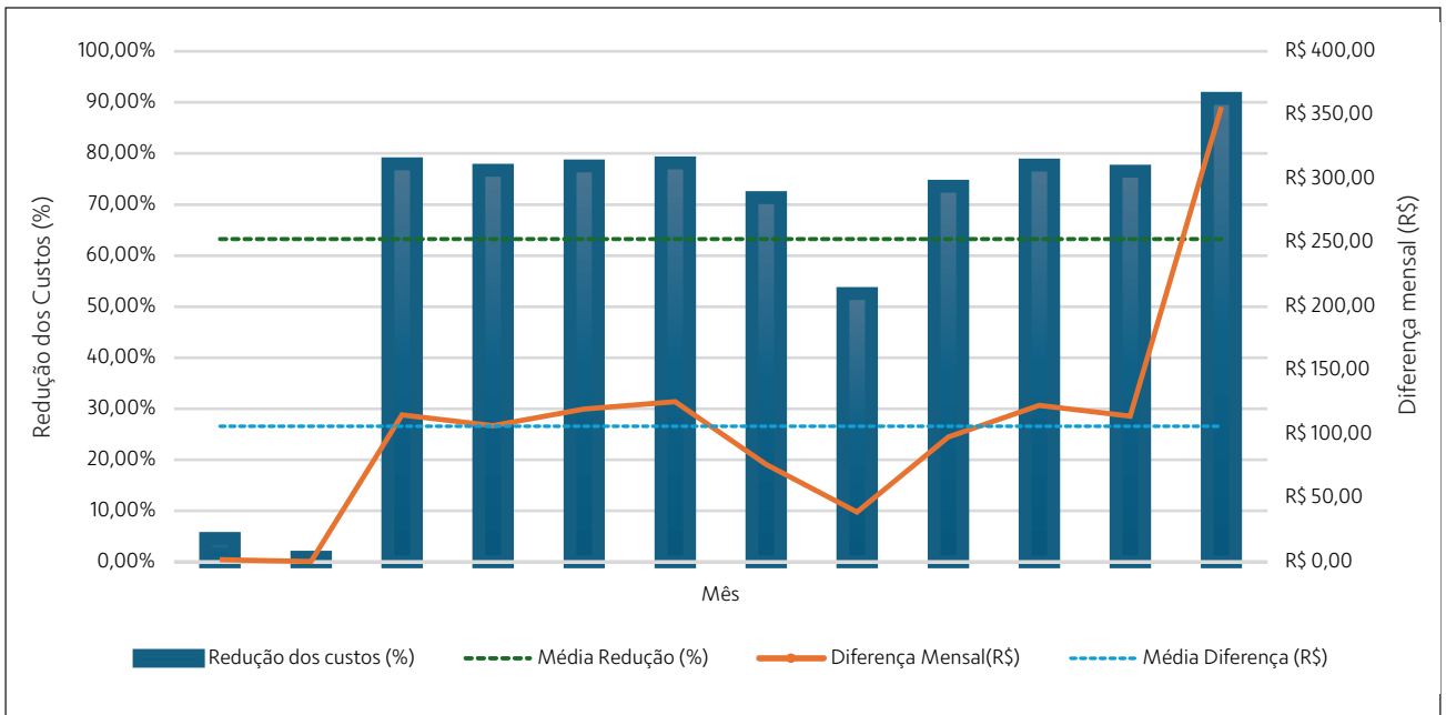
Figura 1 - Redução Percentual e Diferença Mensal dos Valores de Energia Elétrica após Instalação de Placas Solares com Médias. Fonte: Elaborado pelos autores (2024).
