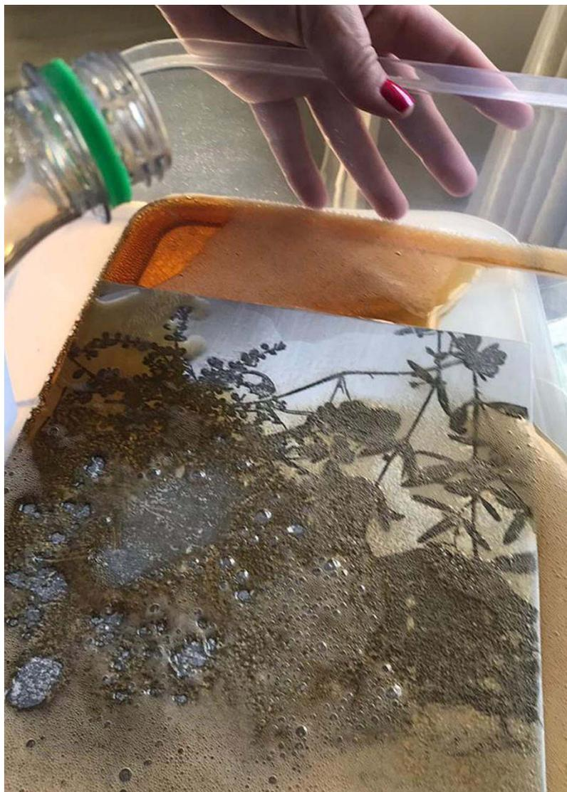
**Figura 5** – Processo de corrosão de placa de *offset* por refrigerante de cola.
