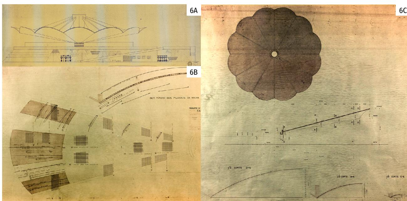
**FIGURA 6** — (A) Vista da fachada com as 12 cascas com mudanças na quantidade e nas posições dos tirantes. Fonte: Abelardo de Souza, Acervo Biblioteca da FAUUSP (1968); (B) Armadura de uma das 12 cascas; (C) Forma da cobertura. Armadura de uma das 12 cascas.
