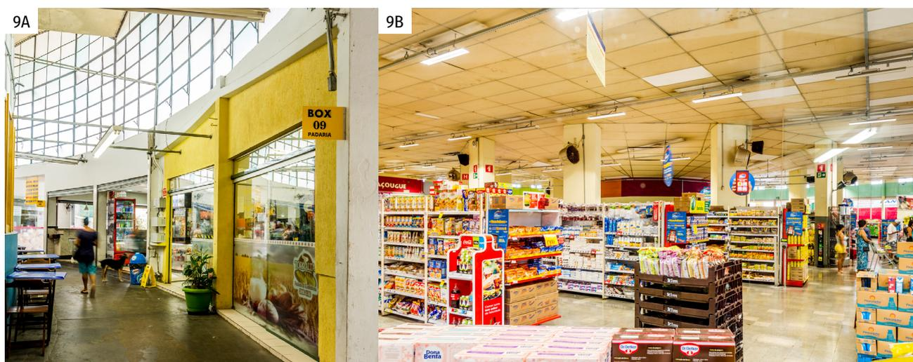
**FIGURA 9** — (A) Fechamento da abertura entre a cobertura e a parede, com caixilhos de aço com vidro; (B) Área do supermercado com gondolas e forro que esconde a cobertura.
