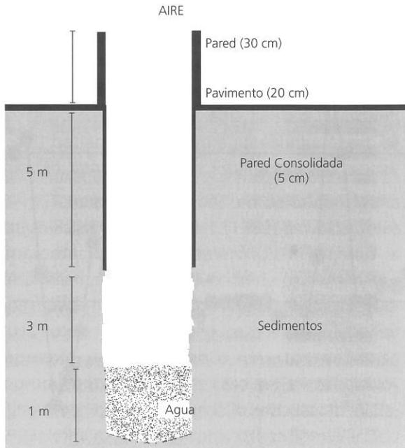
**Figura 2.** Diagrama esquemático del perfil del aljibe.
